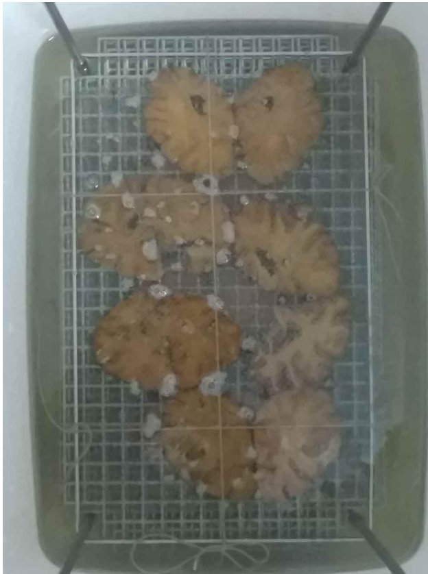
Fig. 2. Burbujeo característico de la impregnación forzada, en la cual las burbujas representan la acetona que está siendo extraída del interior de los cortes, ocupando su espacio la resina poliéster para asegurar la impregnación de las muestras.
