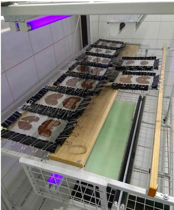
Fig. 6. Cámaras de curado colocadas en el sistema de exposición a luz ultravioleta.
