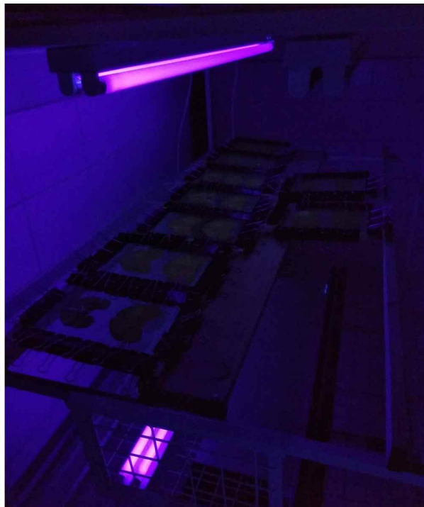
Fig. 6. Cámaras de curado colocadas en el sistema de exposición a luz ultravioleta.
