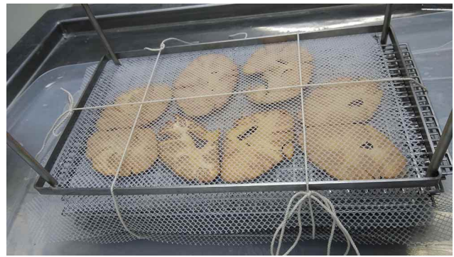
Fig. 1. Muestras dispuestas entre rejillas perforadas conformando, en su conjunto, un paquete que permite movilizar todas las muestras en conjunto evitando el desplazamiento de los cortes, y asegurando su correcta deshidratación y posteriormente impregnación.
